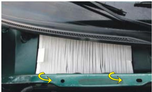
**(PL)** Ostrożnie usunać zabrudzony filtr, następnie zamontować nowy oraz wykonać powyższe czynności w kolejności odwrotnej
